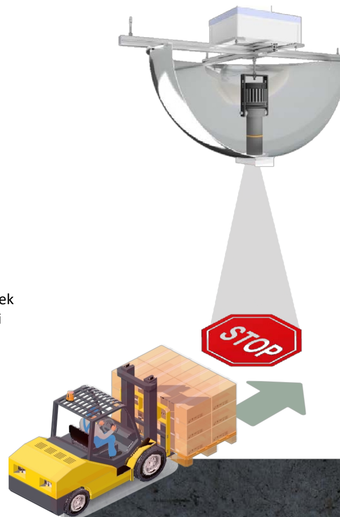
a targonca parabolatükörre való érzékelési irányának észlelése
