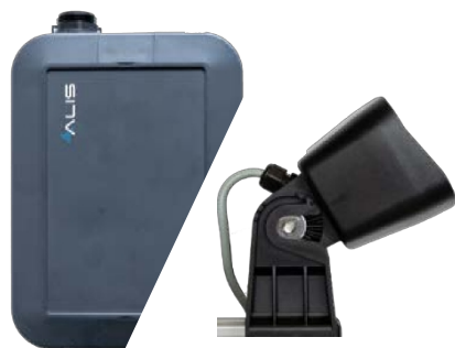
UWB/senzorika a targonca jelenlétének észlelése a kereszteződésben
